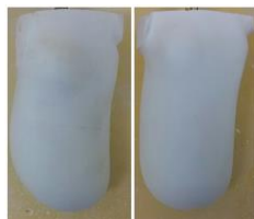
図2 断端形状比較 (左:非荷重 右:半荷重)
